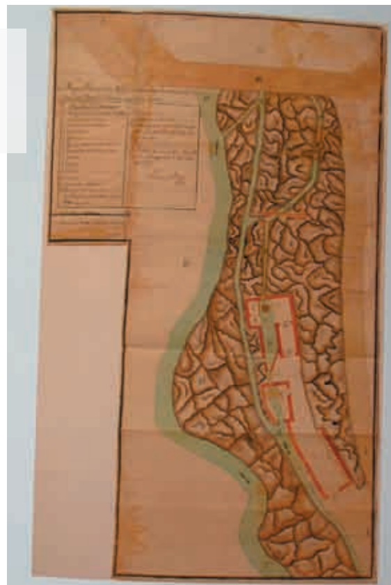
Ilustración 4: Croquis de la planta de la presa de Almonacid, su molino y batán. Arriba, la pared de la presa y el arranque de las acequias. Antonio Ribas, 1787. A.H.P.Z Casa Ducal de Híjar, Sala V. leg. 106 doc. 2
